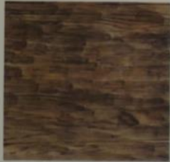
「平行切削」繊維の方向に沿って削る。
